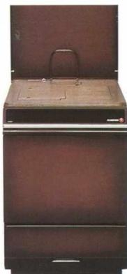
**10260 BL** Chargement par le dessus à double tampon suivant utilisation au bois ou au charbon. Décendrage sur rouleaux. Grand tiroir de ramonage. Réglage d'allure sur le dessus. Tampon de ramonage avec prise de dépression. Départ des fumées dessus ou arrière.
